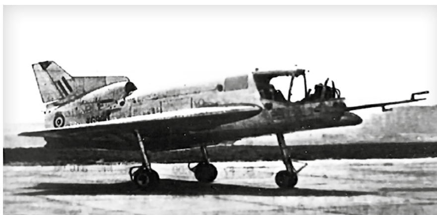
Фото 3. Экспериментальный самолет с вертикальным взлетом и посадкой "Short" SC.1. Фарнборо, 1959 г. РГА в г. Самаре. Ф. Р-220. Оп. 8-6. Д. 10. Л. 89
